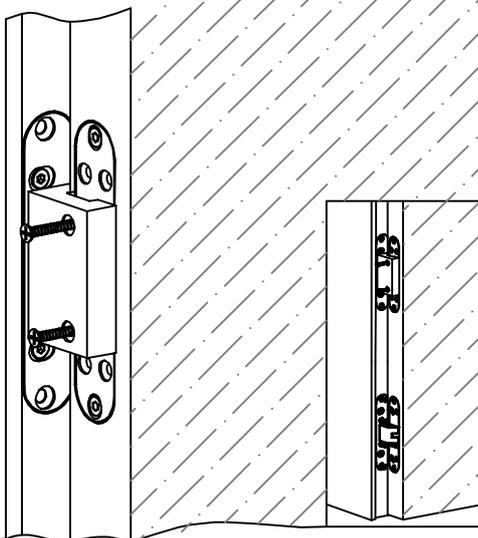
3. 确定安装方向正确（闭门铰链置于上方，阻尼铰链置于下方。）卸下闭门铰链上的定位胶件。
