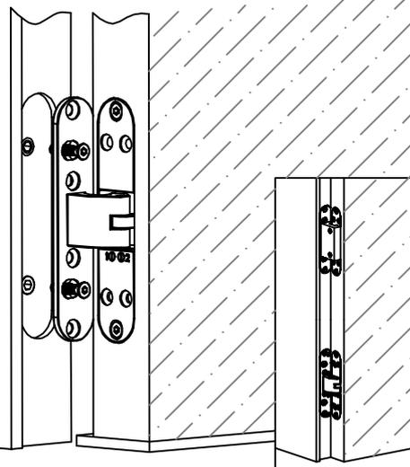
2. 以机牙螺丝将闭门器主体安装在门扇内，垫起门扇打开闭门器至90°，并将闭门器底板以机牙螺丝安装在门框上。
