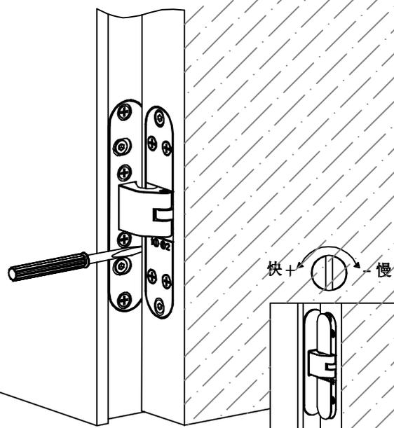
6. 调节阻尼铰链上的阀门螺丝，以求需要的关门速度及闭锁速度。安装面盖，安装完成。
