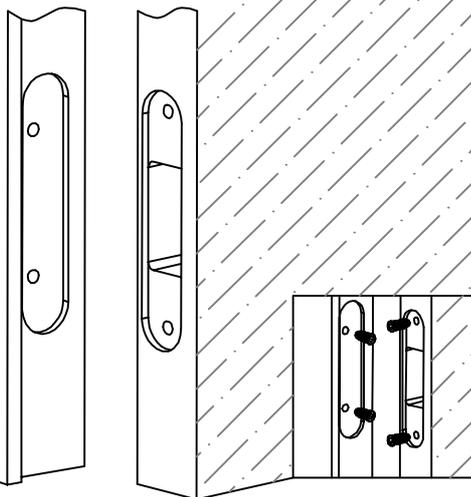
1. 确定安装位置，按照纸规开孔，并安装自攻螺套。
