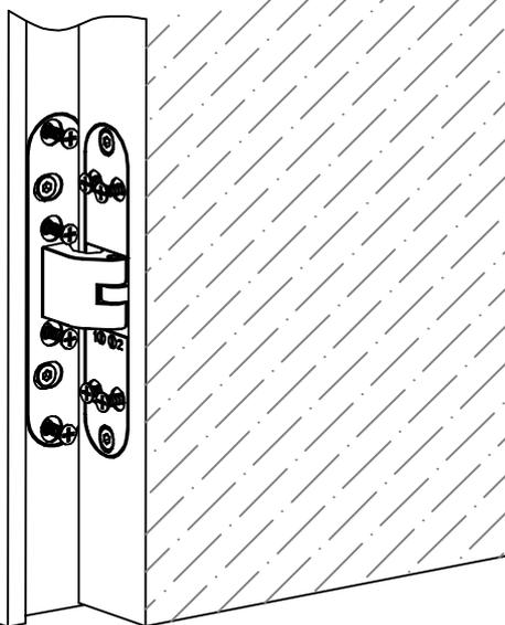
5. 开关门扇，确定操作顺畅及无异声后，安装所有木牙螺丝。
