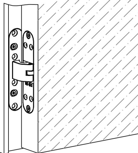
4. 略松机牙螺丝，手动调节门扇方之高低水平度及门框方之内垂直度，完成后收紧所有机牙螺丝。
