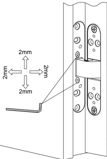
5. 略鬆機螺絲，調節門扇垂直度及水平度，完成後收緊機螺絲。
