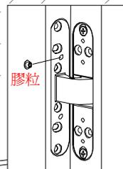
4. 墊起門扇，打開鉸鏈至 90°，並以機螺絲將門框方底座及鉸鏈接合 (注意圖示膠粒已穩妥地安裝在鉸鏈上)。
