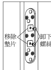
2. 以木牙螺絲安裝門框方底座，移除墊片及卸下機螺絲備用。
