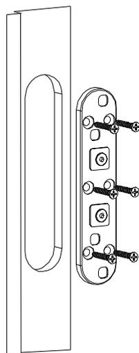
2. 以木牙螺丝安装门框方底座，移除垫片及卸下机螺丝备用。
