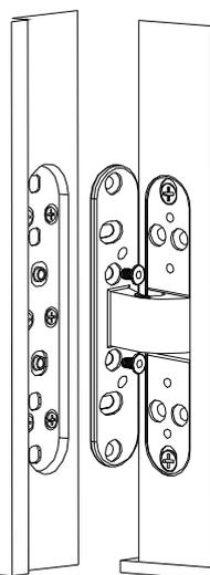
4. 垫起门扇，打开铰链至90°，并以机螺丝将门框方底座及铰链接合（注意图示胶粒已稳妥地安装在铰链上）。
