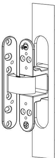
3. 将铰链安装在门扇上（注意图示胶粒应已稳妥地安装在铰链上）。
