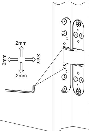
5. 略松机螺丝，调节门扇垂直度及水平度，完成后收紧机螺丝。
