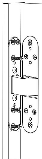
6. 完成检查后，安装余下的木牙螺丝及面盖。安装完成。
