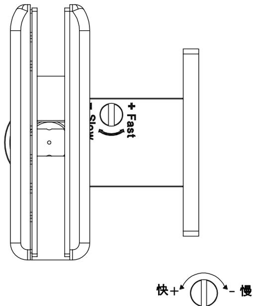
在門扇安裝到牆身或固定玻璃屏後，請移除預安裝的U形定位膠件，以操作門扇。
